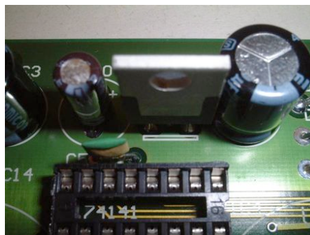
Abbildung 21: Markierung des 7805 Kühlkörpers
