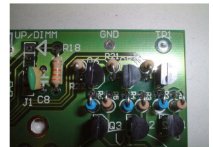
Abbildung 25: Testpunkte TP 1 und GND
