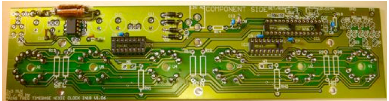
Abbildung 5: Dioden eingelötet und Ansicht der Bestückungsseite der Platine
