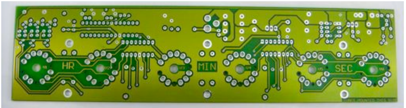
Abbildung 2: Die Lötseite der Platine
