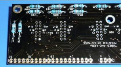
Am besten legen Sie nun ein Brett auf, klammern es fest und drehen die Einheit um. Wir verwenden für alle Einlötbuchsen ein "Baumwoll-Brett" Das Brett hat einen Baumwolllappen aufgeklebt, sodass die Einlötbuchsen schön nieder gedrückt werden:
