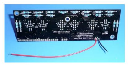
Löten Sie die Anschlussdrähte für die Spannungsversorgung der LEDs wie gezeigt fest:
