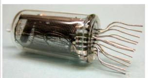
Die Röhren sind bei Lieferung mit einem Sockel versehen, den Sie vor dem Einlöten der Röhre entfernen müssen. Richten Sie die Drähte der Röhre im Sockel korrekt aus, entfernen Sie den Sockel und setzen Sie die Röhre auf die Platine und führen Sie die Drähte in die Bohrungen der Platine.
