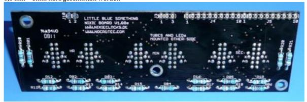
Löten Sie die Anschlussdrähte für die Spannungsversorgung der LEDs in die Platine.
