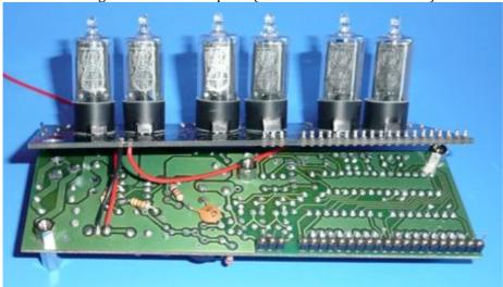
Stecken sie die Platinen sehr vorsichtig zusammen und verschrauben Sie sie mit den M3x4 mm Linsenkopfschrauben.
