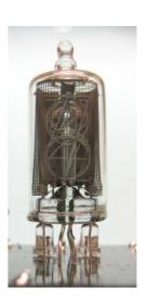
Führen sie mit einem guten Elektronik-Cutter einen Lowcut-Schnitt durch. Das bedeutet alle Pins müssen ca. 0,8 mm – 1mm kurz geschnitten werden
