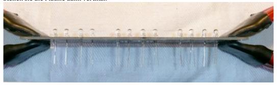
Nun drücken sie von oben die LEDS nach unten und löten von unten die LEDS fest.
