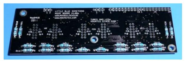
Achtung! Prüfen Sie an dieser Stelle ob die LED Vorwiderstände R10 bis R21 den Wert 1,2 kOhm haben. Diesen Wert empfehlen wir für den Gehäuseeinbau. Frühere Varianten wurden mit anderen Werten ausgeliefert. Falls die Widerstände also einen anderen Wert als 1,2 kOhm haben, tauschen Sie diese aus.
