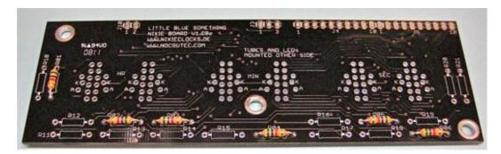
Führen Sie danach einen **Funktionstest der LEDs** durch, **BEVOR** Sie die Röhren einlöten. Legen Sie dazu 5 Volt an die Platine an. Das geschieht an J10. Der Anschluss "2" ist + 5 Volt und der Anschluss "1" ist GND. Sie können dafür ein geregeltes Netzteil verwenden, oder die 5 Volt von der Uhrenplatine abgreifen. (vgl. Punkt 6
